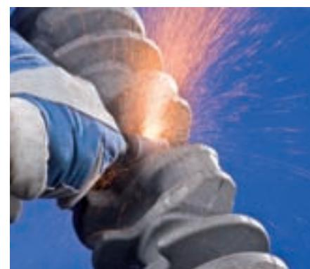
Las muelas con mango especiales de **dureza R para fundición** están fabricadas de un aglomerante cerámico y carburo de silicio gris. La combinación del abrasivo muy duro y afilado con el aglomerante adecuado logran un amolado muy agresivo y baste al tiempo que una gran duración de la herramienta. La dureza R para fundición se recomienda para uso universal y para el amolado con inclusiones de metales en soldadura gris y nodular a velocidad periférica alta.
