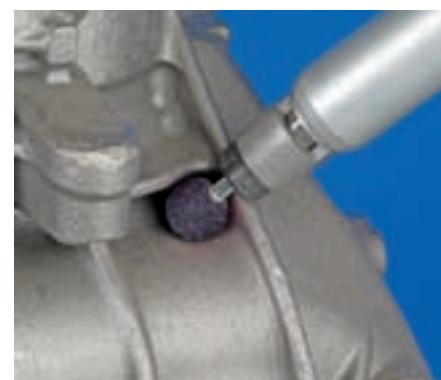
Las muelas con mango de **dureza K** están fabricadas con aglomerante cerámico y una mezcla de grano abrasivo de corindón puro rosa y corindón normal. Esta combinación de grano abrasivo incrustado en un aglomerante semiduro conlleva gran arranque de material y buena duración de la herramienta. La dureza K, combinada con altas velocidades periféricas se recomienda para el uso universal en piezas de fundición.
