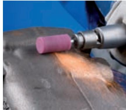
Las muelas con mango especial de **dureza O para fundición** se fabrican de un aglomerante cerámico optimizado y una mezcla de granos abrasivos de corindón fino rosa y rojo. Esta combinación da lugar a un equilibrio entre el arranque de material y la duración de la herramienta, sobre todo en el trabajo de fundición de acero.
