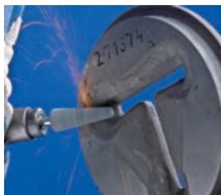
Las muelas con mango de **dureza H** están fabricadas con aglomerante cerámico y una mezcla de grano abrasivo de corindón normal y corindón puro blanco.
