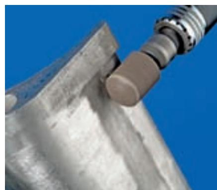
Las muelas con mango de **dureza L** están fabricadas con aglomerante de resina sintética de alta calidad y una mezcla de grano abrasivo de corindón puro blanco y rojo oscuro.
