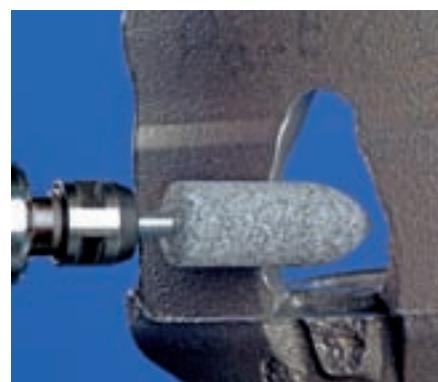
Las muelas con mango de **dureza R** están fabricadas con aglomerante cerámico y carburo de silicio gris. La combinación de abrasivo muy duro con gran contenido de aglomerante conlleva una larga vida útil de la herramienta. La dureza R se recomienda para el canteado y amolado de incrustaciones de metal en fundición gris y fundición nodular con velocidad periférica alta.
