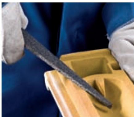
Las puntas abrasivas se recomiendan para mecanizar moldes y machos de arena en fundiciones.
