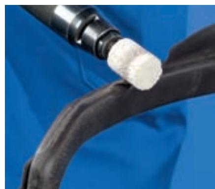
Las muelas con mango de **dureza D** están fabricadas con un aglomerante cerámico especial y corindón de grano hueco (HKK). El bajo contenido de aglomerante en combinación con el corindón de grano hueco de muy fácil fragmentación, consigue el aglomerante de las muelas con mango más blando del programa PFERD. La dureza D se recomienda para uso universal en materiales blandos como plástico, goma y maderas y se caracteriza por su gran agresividad.
