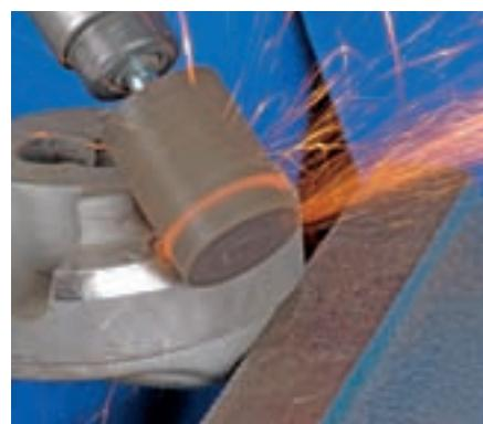
Las muelas con mango de **dureza N** están fabricadas con aglomerante de resina sintética de alta calidad y corindón normal. Un aglomerante relativamente blando unido a la mezcla de granos abrasivos conlleva gran arranque de material y buena duración de la herramienta. La dureza N se recomienda para el canteado en acero fino (INOX). Se caracteriza por el amolado frío manteniéndose la forma de la muela.
