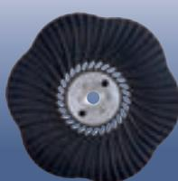
Gracias a este plato soporte los discos de lija COMBICLICK® se pueden utilizar con amoladoras angulares convencionales. La geometría de las ranuras de ventilación del plato soporte garantiza un caudal de aire permanente, de manera que se reducen la carga térmica del abrasivo y la de la herramienta.
