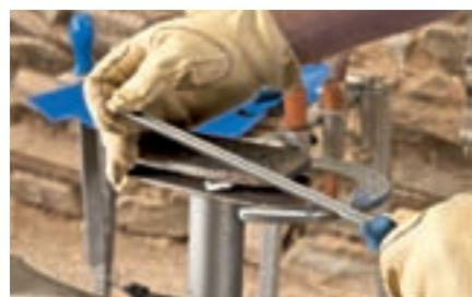
Las limas fresadas de PFERD son adecuadas para el arranque de viruta basto en aluminio y otros metales blandos como, p. ej., latón o cobre, así como acero no endurecido. El dentado no se satura gracias a su forma fresada y agresiva con grandes bolsas. Las limas ofrecen una vida útil muy prolongada y una gran capacidad de arranque.
