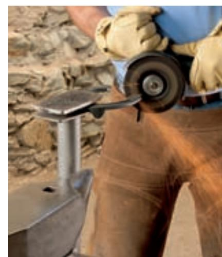
Herramienta versátil para trabajos de amolado de herraduras de aluminio o acero, por ej. trabajos de biselado o desbarbado con gran arranque de material.
