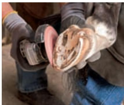
El sistema COMBICLICK® se utiliza para lijar en frío la suela y la muralla del casco. Está compuesto por una combinación de un plato soporte y un disco de lija con soporte de fibra. Las ranuras de ventilación del plato soporte garantizan un caudal de aire permanente, de manera que se reducen la carga térmica del casco y de la herramienta.
