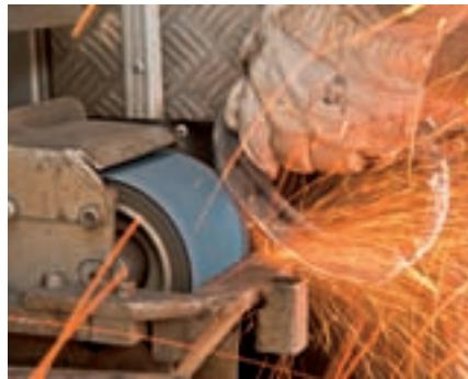
Las bandas de lija Z-FORTE se utilizan en lijadoras de banda parcialmente estacionarias para mecanizar herraduras. Las bandas de lija PFERD Z-FORTE convienen por un lijado muy frío y una prolongada vida útil.
