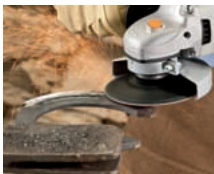
El sistema COMBICLICK® se utiliza para el lijado en frío de acero, acero inoxidable o aluminio. Está compuesto por una combinación de un plato de apoyo y un disco de lija con soporte de fibra. Las ranuras de ventilación del plato garantizan un caudal de aire permanente, de manera que se reduce notablemente la carga térmica de la pieza de mecanizado y de la herramienta.
