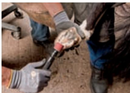
El sistema de manguitos lijadores PFERD se utiliza para tratar la muralla y la pared de los cascos. Se compone de un soporte de manguito y del correspondiente manguito lijador, y se acciona mediante una amoladora recta o un eje flexible.
