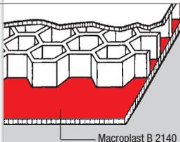
Unión de paneles aislantes a chapa de acero galvanizado.
