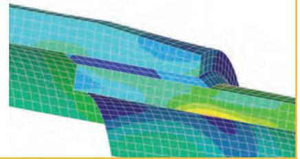
Análisis de la tensión de una junta de tubería adherida.
