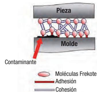
Los contaminantes no deseados pueden impedir la adhesión del desmoldeante Frekote® al molde.
