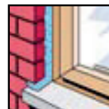
Sellado de juntas de ventana y alrededor del antepecho.
