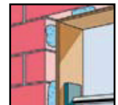
Sellado de juntas de ventana y alrededor del antepecho. Durante el montaje de marcos de puerta, se arristrarán.
