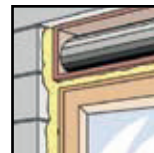
Relleno de huecos alrededor de cajas de persiana.
