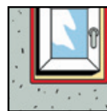
Juntas con poco movimiento (ventanas...)
