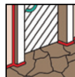
Juntas entre la puerta y la pared.
