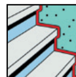
Juntas en torno a peldaños de escalera en interior y exterior.
