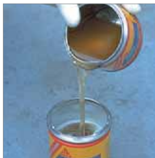
Vertido del componente C sobre la mezcla de A+B.
