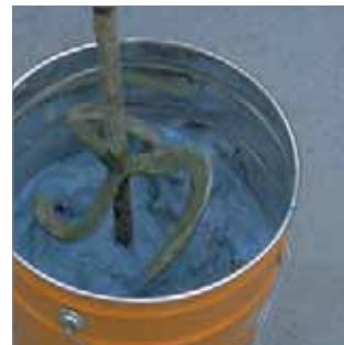
Homogeneización de la mezcla.
