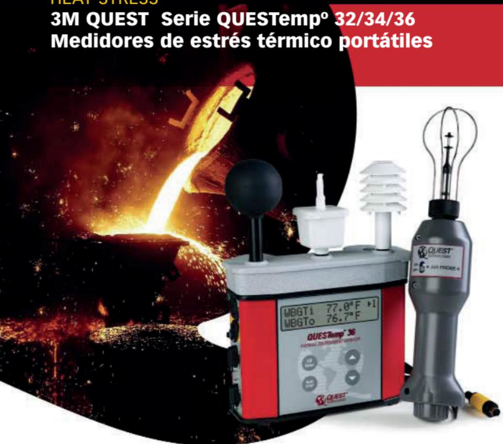
El equipo QUESTemp° le ofrece un dispositivo robusto y fácil de usar para evaluar de forma rápida y precisa la posibilidad de que las personas experimenten estrés térmico. El equipo QUESTemp° agrega lecturas de humedad relativa en tiempo real, además de los cálculos de índice térmico y de humedad.
