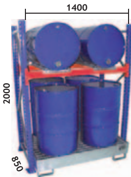
2(en horizontal) + 4(en vertical) x200 l Cubeta colectora: 1380x1000x280mm. Capacidad 243 l. Con enrejado.
