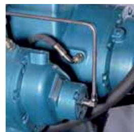
Pistones de equilibrado en elementos de compresión de alta y baja presión que compensan las cargas de los cojinetes y alargan su vida útil
