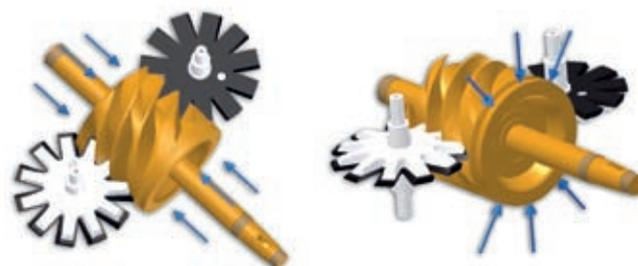
Las cargas axiales actúan en ambos lados del rotor principal
