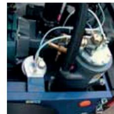
**Engrasador Integrado** para la lubricación optimizada de las herramientas neumáticas
