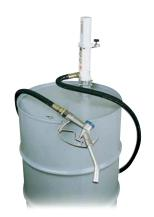
Bomba neumática de baja presión ratio 1:1 con adaptador roscado 2" y tubo de aspiración para bidón de 205 l. Equipada con una manguera de transvase de gran diámetro y boquerel de gran caudal de paso dotado de gatillo bloqueable. Adecuada para el transvase a corta distancia de aceites industriales o de uso en automoción, desde los bidones originales de 205 l. El caudal de entrega de aceite se regula gracias a una válvula situada en la conexión de aire de la bomba. Caudal aprox. 30 l/min.
