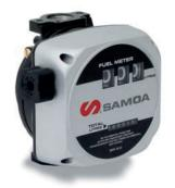
Contadores para carburantes, de utilización exclusiva en operaciones de consumo propio. Fabricados en aluminio inyectado, cámara de medición de discos oscilantes, registrador analógico parcial con resolución en décimas de litro y totalizador. Dispositivo de calibración incorporado para un fácil ajuste del volumen real dispensado.
