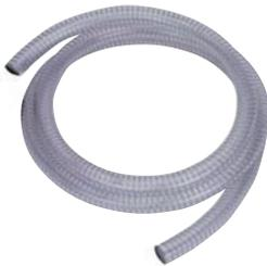
Mangueras flexibles de aspiración de gasóleo para conexión de las electrobombas a depósitos de combustible, diámetro de la manguera 25 mm. Montadas con racor de acoplamiento a manguera con abrazadera y conexión a la aspiración de la bomba M 1" G, así como filtro de aspiración con válvula de fondo.
