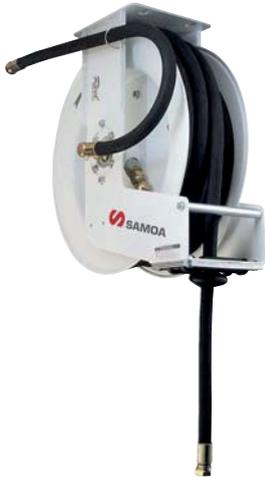
Enrolladores de manguera para gasóleo Ø 19 o 25 mm según modelos. Capacidad máxima de manguera 15 o 20 m, según modelos. Calidad industrial. Enrollador automático accionado por resorte, de sólida construcción que permite su utilización en exteriores o vehículos de abastecimiento a pie de máquina.
