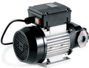
Electrobombas para transvase de aceites ligeros y gasóleo. Dotadas de motor auto ventilado, protección IP-55, bomba auto cebante de paletas ajustables. Cuerpo de la bomba realizado en fundición con tratamiento anticorrosión. Provistas de válvula by-pass de recirculación regulable.
