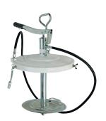
Bomba de engrase construida en acero para acoplamiento directo sobre bidones originales de grasa. Presión máxima: 350 bar. Entrega por ciclo: 2 cc. La bomba, dotada de empuñadura de transporte, va provista de tapa con adaptador, disco seguidor y flexible de 1,5 m terminando en acoplamiento rígido con boquilla cuatro grapas con válvula (715 520).
