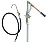
Bomba de accionamiento a palanca de alto rendimiento para suministro de lubricantes desde bidones de 60 o 205 l. Cuerpo de bomba, pistón y palanca de sólida construcción con cuatro posiciones de ataque, que permiten una entrega de fluido precisa según la posición de la palanca (150, 200 y 250 cc por ciclo). Conexión a bidón M 2"G.
