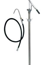
Bombas para dispensar lubricantes de alta viscosidad. Con adaptador ajustable M 2"G (360 007). Para acoplar directamente sobre bidones, tapas o carenados de protección. Bombas con tubo de acero para aspiración, válvula de pie y pistón de acero con junta de caucho nitrílico. Conexión M 3/4"G. Entrega: 100 cc por ciclo.
