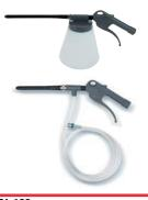
Pistolas ligeras fabricadas en termoplástico de alta calidad que les confieren una gran resistencia guímica. Para ser utilizadas con productos desengrasantes en limpieza de las partes inaccesibles de motores de coches, camiones, tractores, barcos, maquinaria de obra, etc... Boquilla de salida regulable. Capacidad depósito: 0,75 l. Presión de aire mínima/máxima: 6/12 bar. Consumo aire: max. 100 l/min a 8 bar. Rosca de conexión: H 1/4"G.
