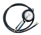
Pistola para llenado por gatillo y vaciado por botón purgador. Manómetro de construcción integral sobre el propio cuerpo de la pistola. Homologada y verificada oficialmente de acuerdo a la directiva 86/217 CEE. Flexible de 1.560 mm con boquilla autosujetable. Conexión para manguera de Ø 8 mm con rosca de entrada H 1/4"G.
