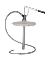
Para todo tipo de lubricantes viscosos (aceite de engranajes). Bomba de media presión de construcción totalmente metalica, con flexible transparente reforzado de 1,5 m y boquilla en codo a 135°. Bomba fijada sobre tapa para bidones de parte superior abierta. Entrega 100 cc por ciclo.
