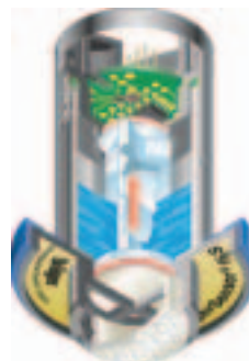
Sensor electroquímico DrägerSensor® Esquema interior del sensor
