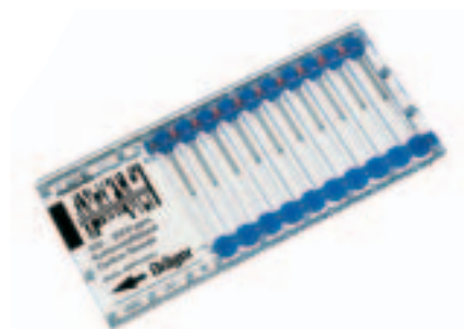
Dräger CMS Chip Previsto para 10 mediciones de un tipo de gas. Proporciona al analizador automáticamente datos de la calibración y del rango de medida del gas.
