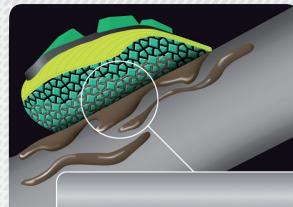
Las placas protectoras de SuperFabric® evacuan el lubricante, creando un efecto "neumático de nieve". De esta forma, el usuario puede sujetar piezas y herramientas con grasa o lubricadas.
