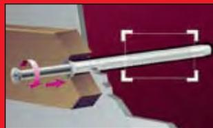
El roscado del tornillo produce el desplazamiento lateral de las láminas.
