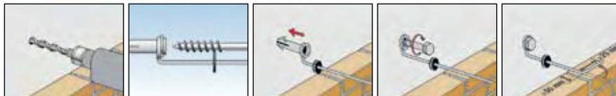
En el hormigón con celdillas, la elaboración del taladro se debe llevar a cabo con el portapunzón fisher para hormigón con celdillas GBS.
