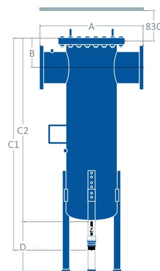
**Filtros con brida (L080-L304):** carcasa de acero C; alojamiento de los elementos de acero inoxidable; fabricación/comprobación conforme a DGRL97/23/EG/AD2000; pintura exterior; bridas según DIN 2633 para una sobrepresión de funcionamiento de 16 bar (a partir de L204, máx. 10 bar) con BEKOMAT®; patas regulables opcionales. Todos los indicadores de volumen/caudal se refieren a 1 bar absoluto y 20° C.
