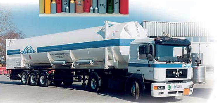
Suministro de hidrógeno líquido en camión cisterna
