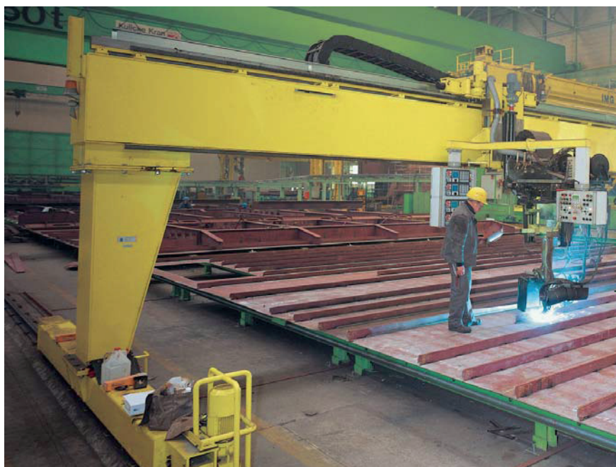
Velocidades de soldadura de 150 cm/min en soldadura MAG Tándem bajo CORGON ® He 30 en construcción naval
