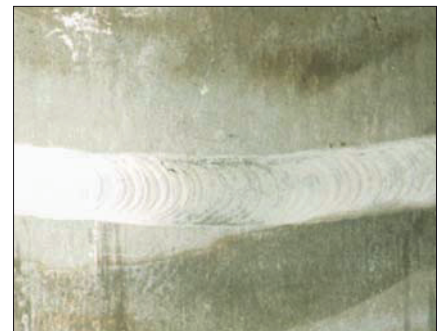
No hay coloración: acero al Cr Ni, estabilizado con titanio, protegido con hidrógeno
