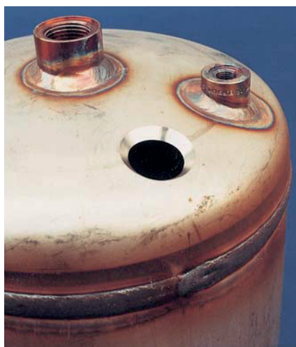
Racores de depósito soldados por TIG.
