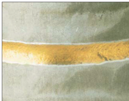
Coloración amarilla característica: acero al Cr Ni, estabilizado con titanio, protegido con nitrógeno
