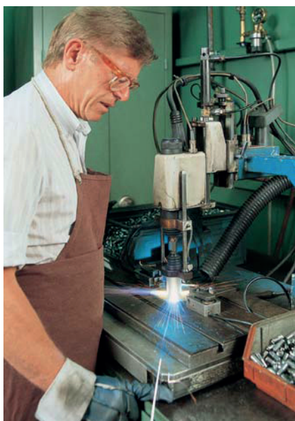
Espárragos de acero y de aluminio soldados bajo gas protector
