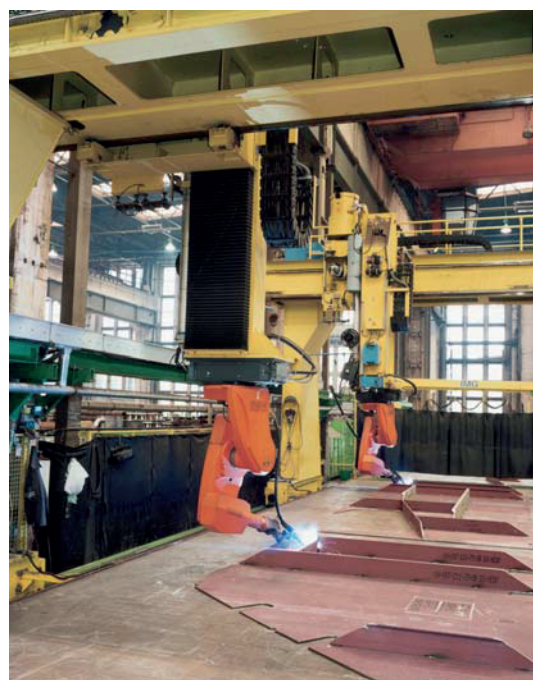
Utilización de CORGON® 15 en la soldadura robotizada
