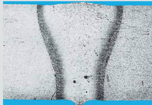
Desarrollo de plasma y comportamiento de la penetración en el láser de CO 2 con diversos gases protectores.
