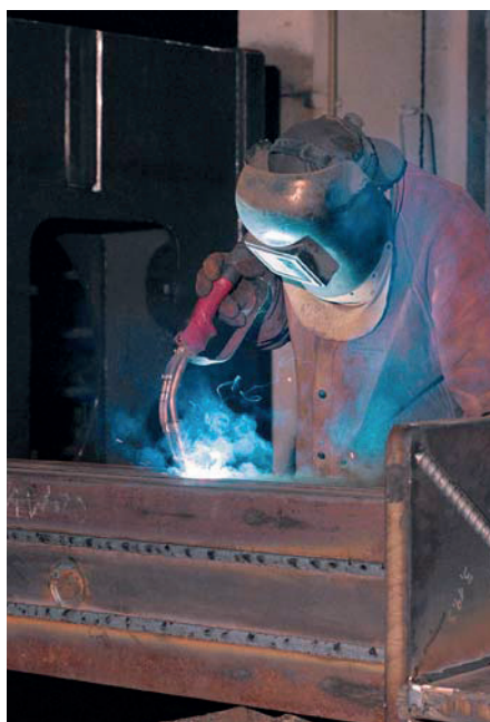
Soldadura MAG-HL manual en la construcción de maquinaria pesada, con mezclas de gases CORGON ® He
