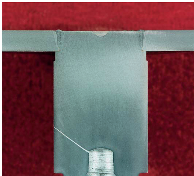
Leva de distribución soldado con láser de CO 2
