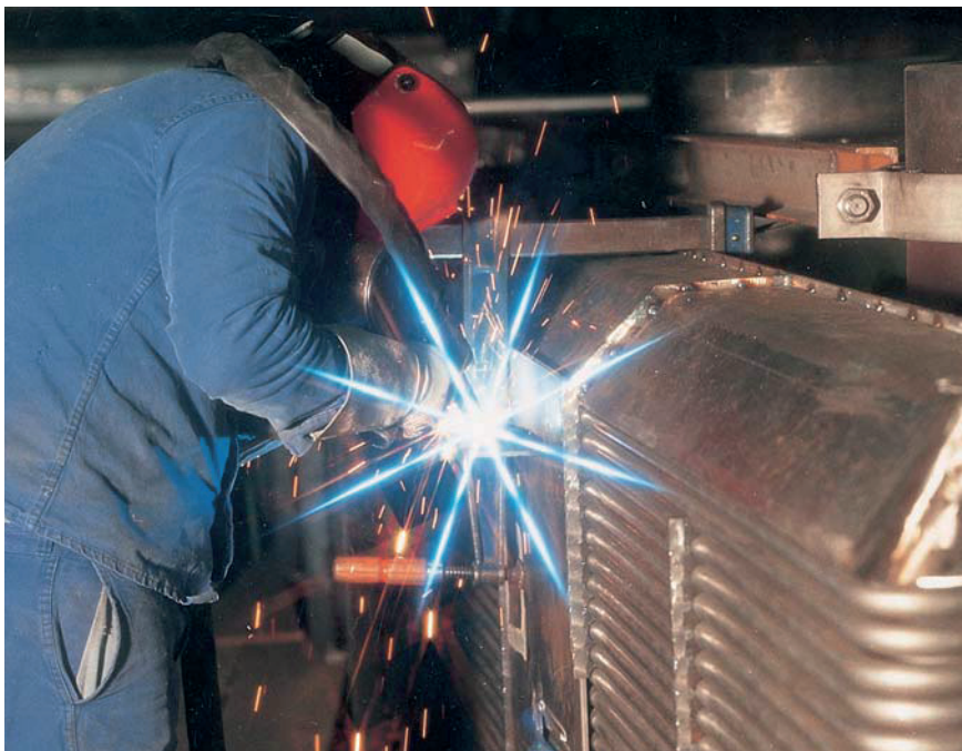
Soldadura MIG de intercambiadores de calor de aluminio con mezcla Ar/He
