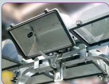
Base de apoyo de los focos
