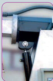
Cilindro de elevación (versión hidráulica)
