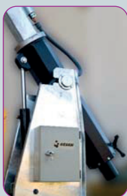
Cuadro eléctrico de elevación (versión hidráulica)
