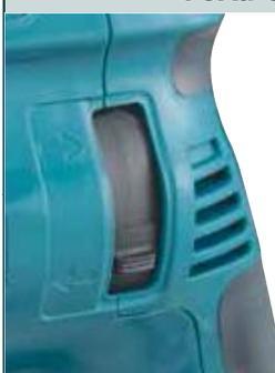
Para inversión de giro. Permite cambiar la posición de las escobillas respecto al inducido consiguiendo así más potencia y alargando la vida de las escobillas 3 veces más.
