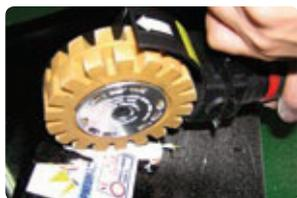
Con el disco borrador eliminaremos fácilmente todo tipo de adhesivos o masillas.
