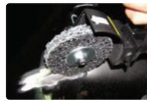
Con el disco de fibra abrasiva limpiaremos cualquier soldadura y eliminaremos óxidos y pinturas, en superficies planas.
