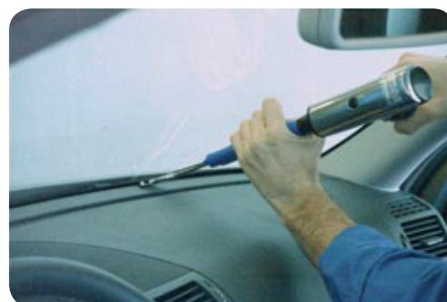
Este desmontalunas de sable facilita el trabajo para desmontar los parabrisas de automóviles o vehículos industriales. La longitud de las cuchillas le permite acceder a las zonas más difíciles en todo el perímetro del cristal desde el interior del vehículo, sin dañar las partes exteriores de la carrocería. El movimiento de la cuchilla en forma longitudinal permite, al mismo tiempo que desplazamos la máquina, cortar el poliuretano sin demasiado esfuerzo.
