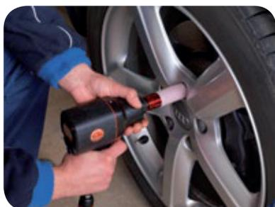
Aproxime la llave de vaso al tornillo y con la llave de impacto efectúe el apriete con una duración de entre 3-5 segundos. Para aflojar no encontrará ninguna resistencia, esta potente herramienta desarrolla su máxima potencia que es de 85 Kg/m.
