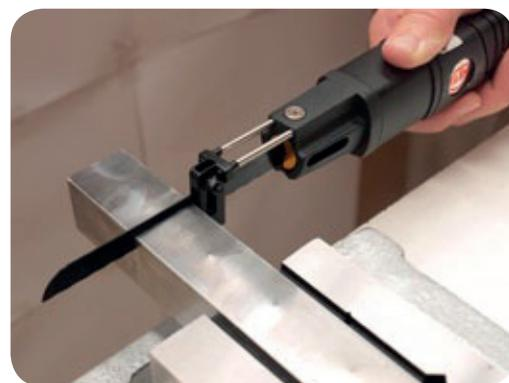
Su funcionamiento longitudinal le permite realizar de manera eficaz cortes sobre acero, chapa, fibra, plástico y otros materiales. Recuerde que la capacidad de corte de la máquina puede variar en función del tipo de material y la dureza del mismo.
