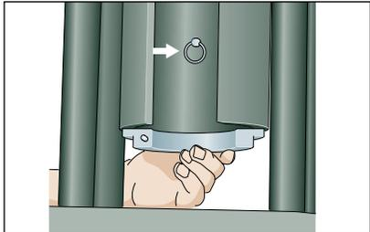
Con el empujador en la posición más elevada, levante la mitad trasera del anillo de empuje. Fíjelo en la posición superior presionando el pasador hacia dentro (el pasador está en la parte trasera del empujador).
