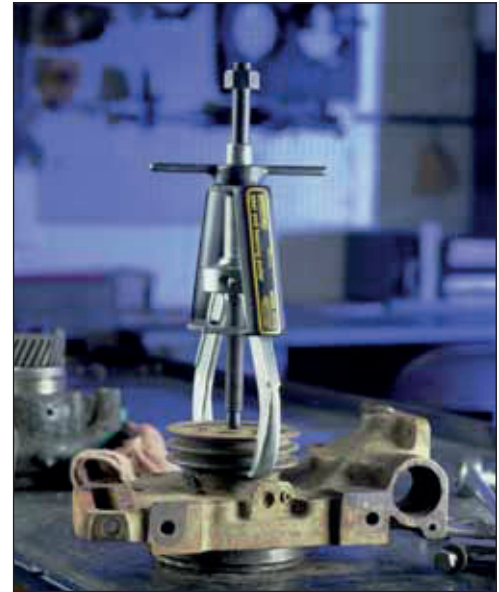
▲ Un extractor de 2 garras EP-204 listo para extraer la polea de una bomba de agua.
