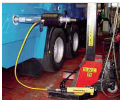
◀ Un cilindro RACH-306 alimentado por una bomba de mano ligera P-392 utilizado para extraer pernos corroidos de vehículos de recogida de basura.
