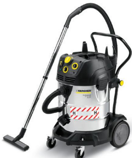
Para la aspiración segura de polvos patógenos y cancerígenos (por ejemplo, el amianto), se requiere el aspirador de seguridad de la categoría de polvo H. Con una capacidad de retención de polvo del 99,995 %, sistema antiestático y accesorios electroconductores, nuestros aspiradores de seguridad H proporcionan una seguridad absoluta y un cómodo manejo.
