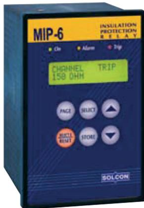
El MIP-6 controla el nivel de deterioramiento del aislamiento del motor, en baja y media tensión. Mide la resistencia de aislamiento entre el motor y tierra e indica los valores real y medios mayores y menores en un periodo de tiempo predefinido.
