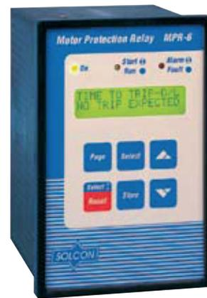
El MPR-6-DGF controla las tres fases de corriente, corriente a tierra direccional, temperatura del motor (tres RTD's / Termistores) y crea un "Modelo Térmico" exacto del motor para protegerlo de condiciones anormales debidas a fallos de la alimentación, del cableado, del propio motor, así como, con el fallo a tierra direccional protege de fugas a tierra en barcos y hospitales, donde la tierra convencional es complicada.
