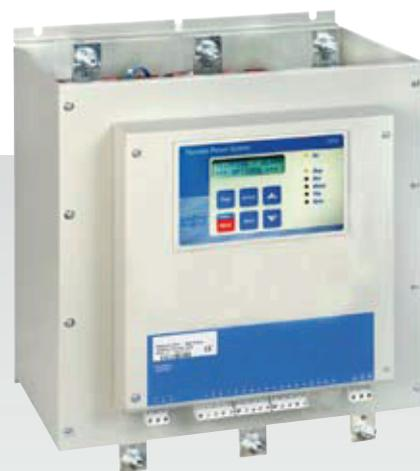
Sistema controlador de tensión/calor por tiristores totalmente digital. El TPS controla la tensión aplicada a cargas de elementos calefactores, unidades de potencia de una, dos o tres fases. El TPS permite un control automático y continuo de temperatura, eliminando el contactor de conmutación y la sobre/baja temperatura. Sus características estándar son: control de fase, paso por cero, entrada PID, control por potenciómetro local, comunicación RS 485 y mas.
