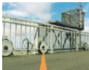
Ruedas de Vulkollan® (95° Shore A) \phi 500 mm. y 100mm. de ancho de banda. Material colado sobre núcleo de aluminio anodizado (para reducir significativamente el peso, facilitar la manipulación y prevenir la corrosión).
