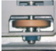
Chimeneas giratorias. Ruedas motrices de \phi 300 mm. con núcleo de acero y banda de Vulkollan®, y eje sujeto con chaveta.
