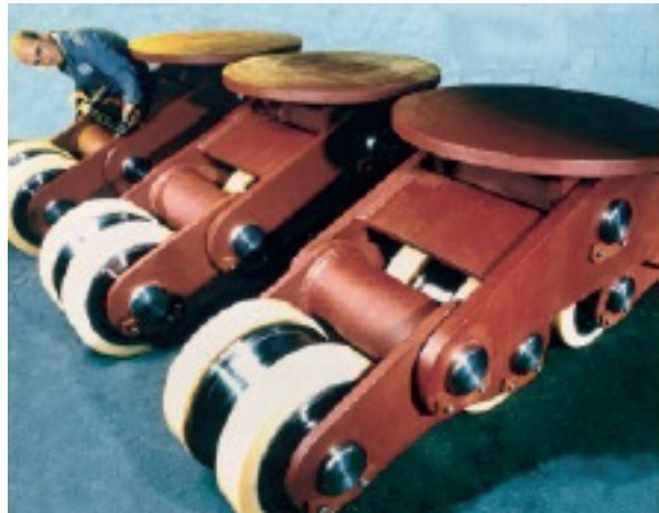
7.600 toneladas y 32 metros de diámetro, girando sobre ruedas de acero de doble pestaña sobre riel, con casquillos autolubricantes. Rueda \phi 450 mm. y ancho de banda 112 mm.
