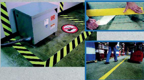
Cintas de marcaje están especialmente indicadas para suelos industriales, superficies porosas, viejas, irregulares y sucias. Resistentes a tráfico de maquinaria y carretillas. Diseñadas con bordes aplanados y dotadas de pegamento de goma extrema.
