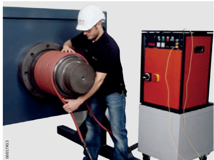
Figura 1 Es posible envolver la pieza con el inductor flexible
