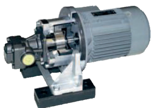
Equipación de una bomba de engranaje con MINEX® SA 75/10, campana PK 200/30, brida de apoyo y barra amortiguadora
