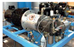
Estanqueidad sin mantenimiento de bomba de dosificación de polio e isocianato en máquinas de moldeado a alta presión
