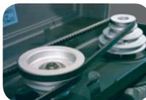
Poleas de aluminio con correas dentadas mejorando la tracción y reduciendo las vibraciones.
