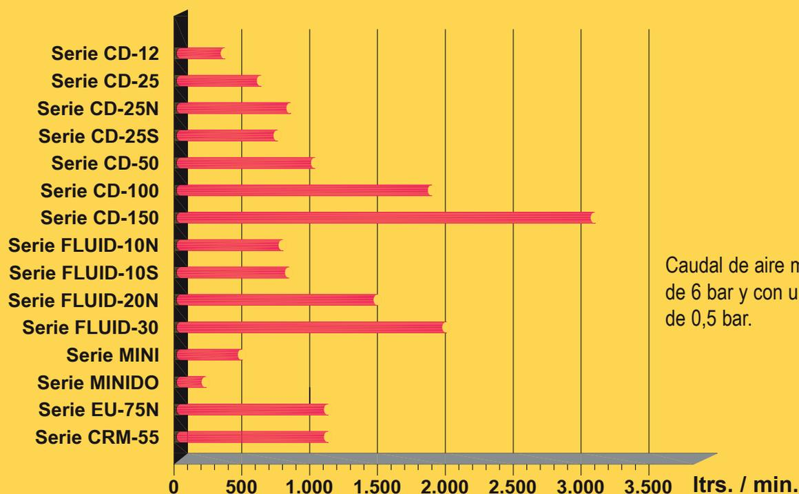
Caudal de aire medido a una presión de 6 bar y con una pérdida de carga de 0,5 bar.
